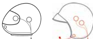
COHS headset s výměnnými mikrofony pro instalaci v integrální a odklopné přilbě
